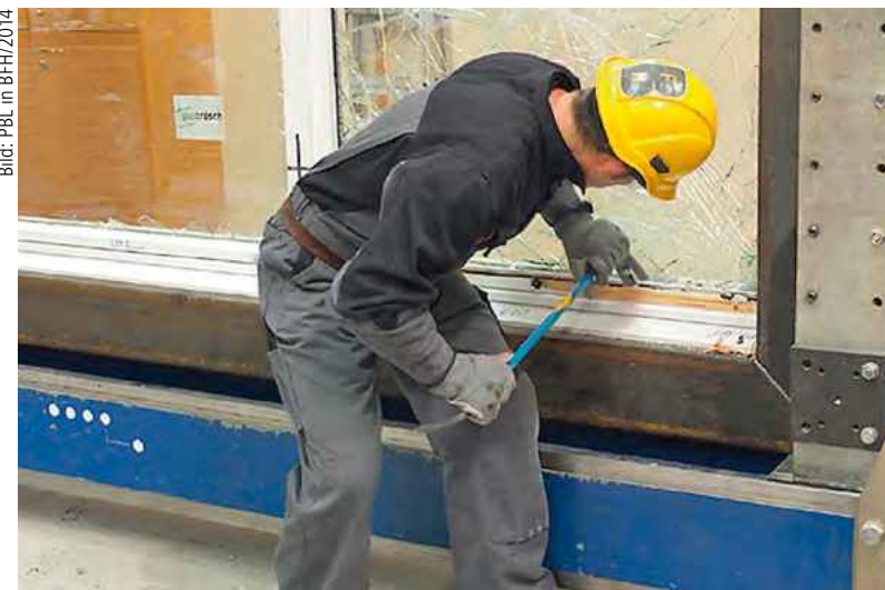
Test-Einbruchversuch am Fenster anlässlich eines Prüfverfahrens.
